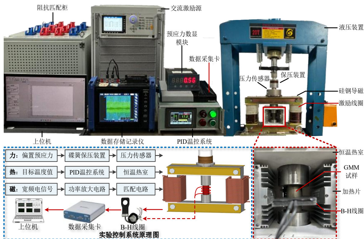
图 1 超磁致伸缩材料热-力-磁多物理场联合测试平台
