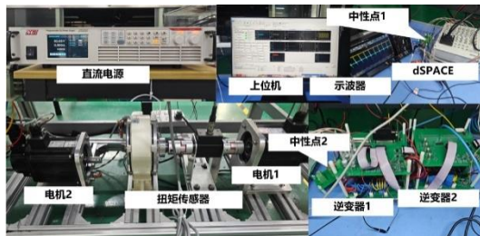
图 11 中性点供电的电驱系统实验平台
